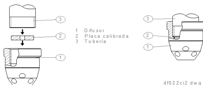
Fig. 14: Detalle de montaje de un difusor y la placa calibrada.
