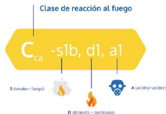
Fig. 23: Nomenclatura en cable según nueva CPR.
